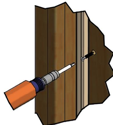
Si présence de trou pré-percé sur le côté du volet, mettre la vis de 3" à 45° pour maintenir le volet fixe au seuil puis visser la plaque de plastique sur le côté du volet avec la vis de 1 1/2" .
