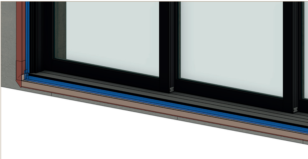
Vue de détail d'étanchéité extérieure
