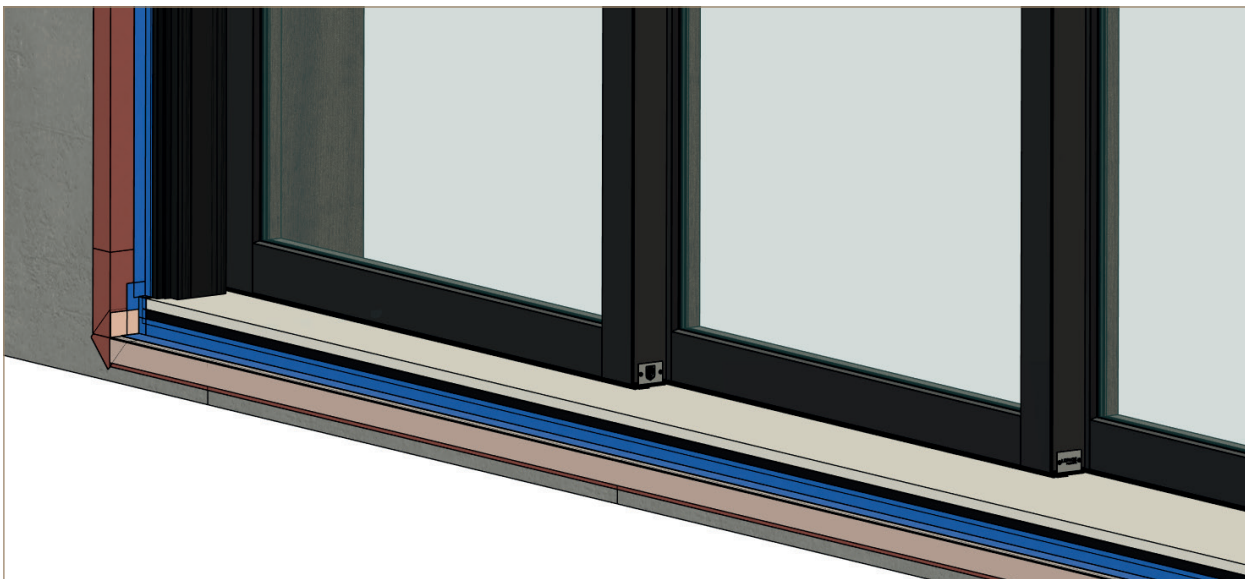
Vue de détail d'étanchéité extérieure
