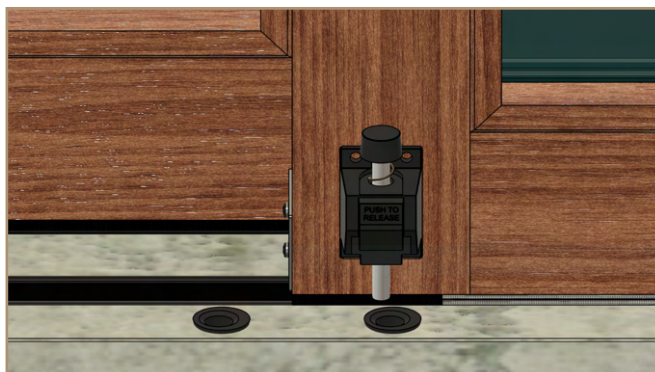
Installation des réceptacles
