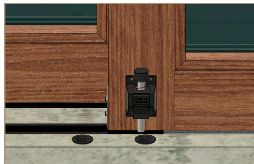
Installation des réceptacles
