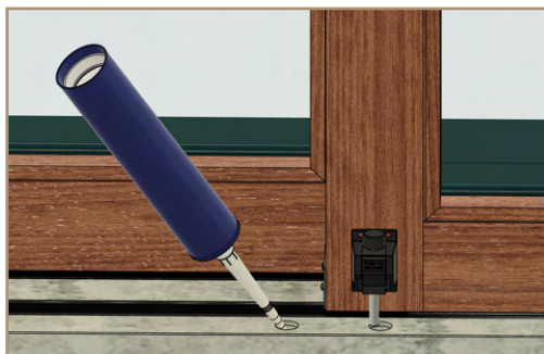
Aplicación del adhesivo
