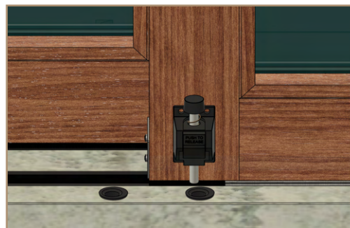
Instalación de los receptáculos
