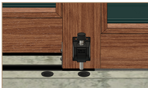
Instalación de los receptáculos
