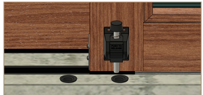
Instalación de los receptáculos
