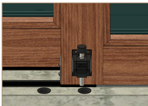
Instalación de los receptáculos
